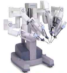
医師はケーブルでつながった操作台に座り、3次元立体画像を見ながら遠隔操作で手術を行う
