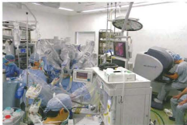
「ダ・ヴィンチ」によるロボット支援前立腺全摘術の様子。術者(右端)はコンソールに座った状態で両手両足を使得ってロボットアーム(中央左)を操作する。
